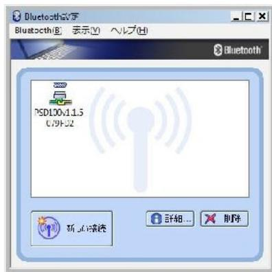
この時点でUSB dongle側はペアリング状態になっていますが、Parani-SD1000のLEDを見るとCONNECT LEDがまだ点滅状態です。これはBluetooth 接続が行われていても、実際のポートが開いていない為です。
