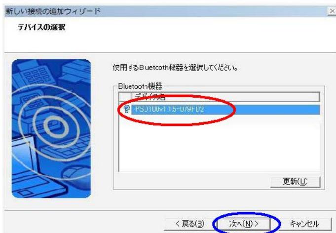
2-6. 表示されている「PSD100v1.1.5-079FD2」をクリックして選択し「次へ」をクリック。
